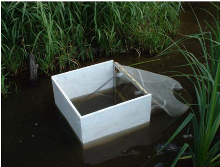
Figure 8 : Vue d'ensemble du dispositif de prélèvement.
