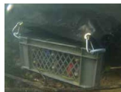
Système d'immersion contenant les cages des gammare
