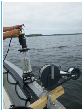
Prélèvement à la bouteille intégratrice
