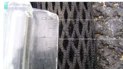
Mailage du petit chasut à perche utilisé au sud du chasut (5 mm X 5 mm)
