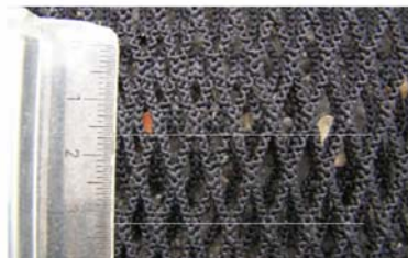
Mailage du petit chasut à perche utilisé dans partie médiane du chasut (8 mm X 8 mm)
