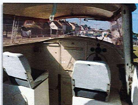
Photo 2 : Détail du poste de pilotage entièrement couvert. Ceci permet d'embarquer du matériel informatique qui reste protégé lors de l'enregistrement des traits de chalut.
