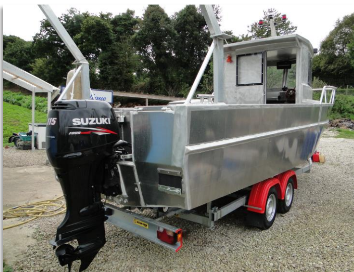
Photo 2 : Vue générale depuis l'arrière. Le poste de pilotage couvert permet d'embarquer du matériel informatique qui reste protégé lors de l'enregistrement
