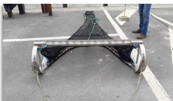
Photo 3 : Chalut à perche de 1,6m. La perche a été renforcée pour l'usage sur des canots professionnels munis d'un dispositif puissant de relevage (hydraulique).
