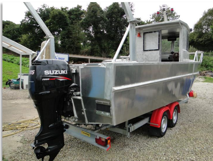
Photo 2 : Vue générale depuis l'arrière. Le poste de pilotage couvert permet d'embarquer du matériel informatique qui reste protégé lors de l'enregistrement des traits de chalut.
