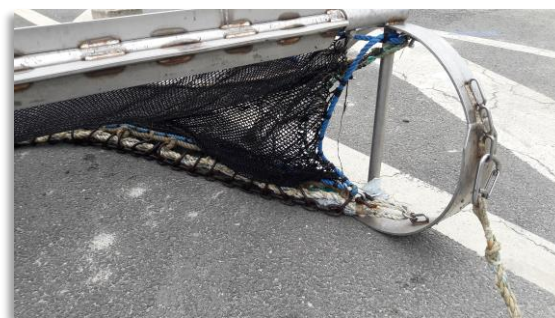
Photo 4 : Modification du bourrelet adoptée sur les deux types de chalut à perche. Réglage pour que la chaîne et les bagues travaillent toujours en avant de la corde de ventre..
