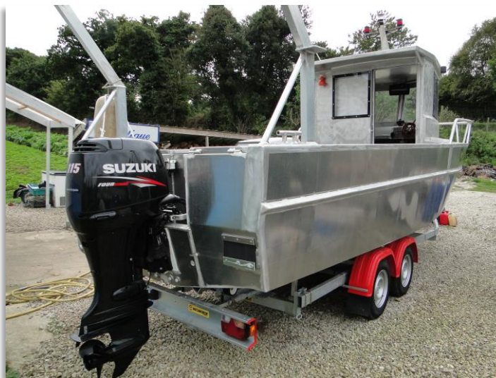
Photo 2 : Vue générale depuis l'arrière. Le poste de pilotage couvert permet d'embarquer du matériel informatique qui reste protégé lors de l'enregistrement des traits de chalut.
