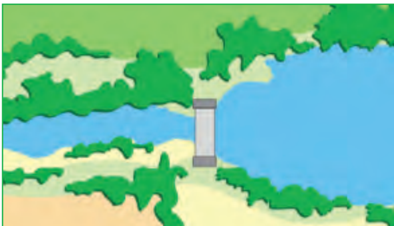
Ouvrage infranchissable et « effet retenue »
