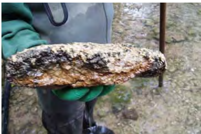
Concrétion calcaire présente sur plusieurs plateaux décolmatés
