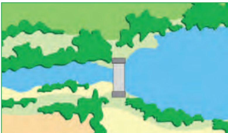
Ouvrage infranchissable et « effet retenue »
